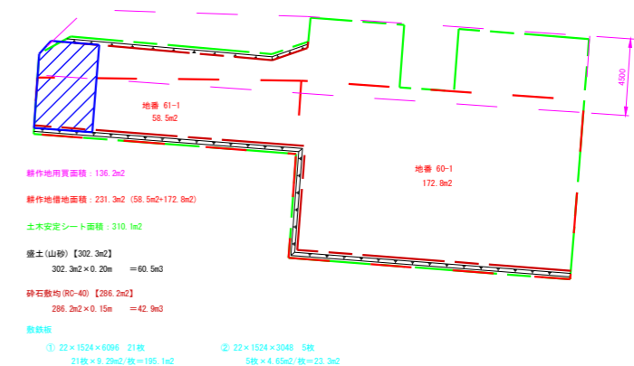
到達立坑作業ヤード
